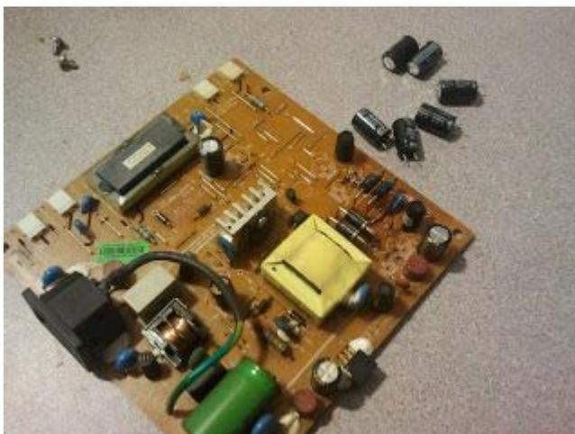
A la hora de cambiar los condensadores que se hayan inflado es importante respetar el voltaje y nunca poner otro condensador nuevo de menor voltaje. Para retirarlos con un soldador de estaño, calentar una de las conexiones del condensador, y tirar levemente de ese lado, para a continuación calentar la otra y proceder de la misma manera con el otro lado. No tirar demasiado porque podemos romper la patilla del condensador y que se quede en la placa o llegar a quitar el Pad.
