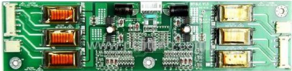
En la imagen podemos ver los componentes que forman el inverter en una TV LCD.
