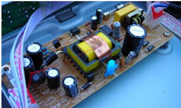
7. Si estamos ante una fuente con Circuito Integrado, debemos controlar que sólo los pines de tierra tengan continuidad con la misma. Si otros que no están directamente conectados a ésta, poseen continuidad a GND, desconectarlas, chequear que el circuito integrado no sea el responsable y en el peor de los casos o en situación de dudas reemplazar el Circuito Integrado. Estos componentes son algo complicados de conseguir en el
